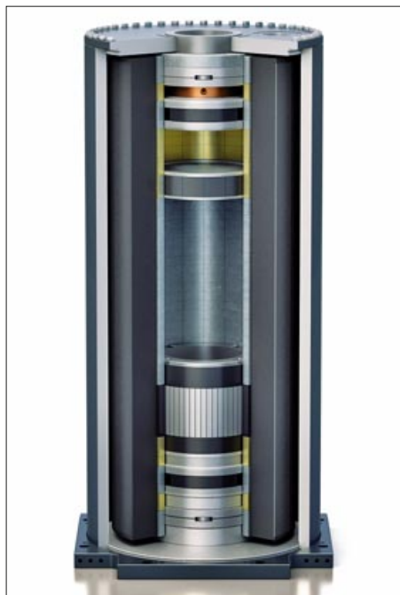
Als energetisch optimierter Hohlzylinder ist der Kreisel gefertigt aus hoch speicherfähigem Kohlenstoff-Material und rotiert mit bis zu 18.000 Umdrehungen pro Minute berührungsfrei in einer Magnetlagerung im Hochvakuum. Abbildung: ABP GmbH
