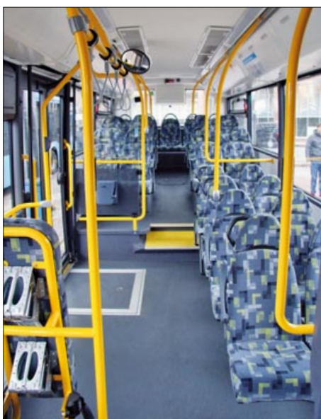
Der VDL-Elektro-Midibus der VGG kann 66 Fahrgäste befördern; es gibt (laut Aufkleber) 28 Sitzplätze, einen Rollstuhlplatz und bis zu 40 Stehplätze.
