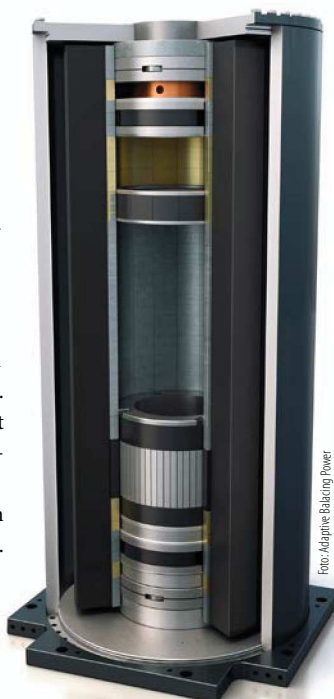
So sieht es im Inneren des Schwungradspeichers aus. Die Schwungmasse rotiert auf Magnetlagern im Vakuum.
